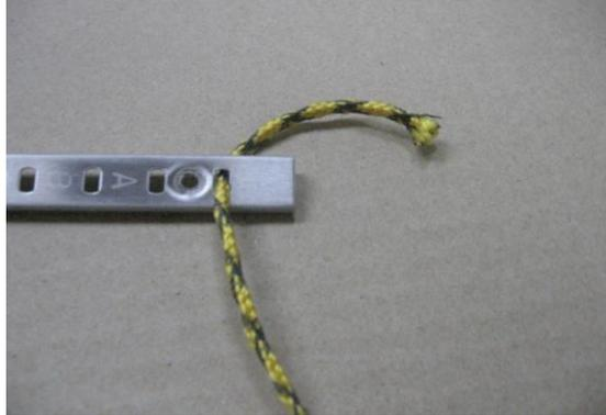
③部材の裏側で除電組紐外れない様に縛る。④除電組紐の必要数を裏側で縛った状態。
